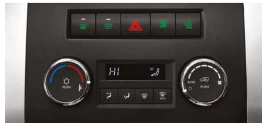
Система отопления, вентиляции и кондиционирования с функцией климат-контроля
