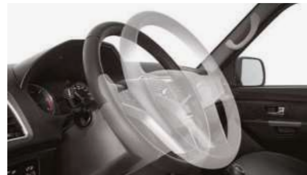
В УАЗ Патриот регулировка рулевого колеса осуществляется как по углу наклона, так и по вылету
