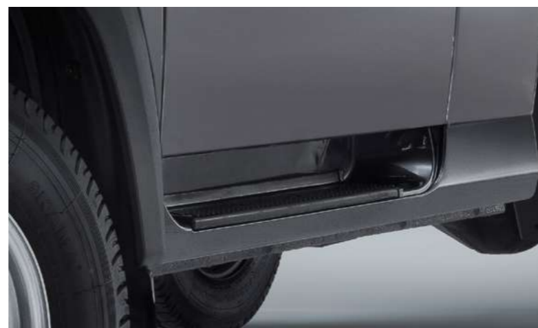
Подножки с противоскользящим покрытием
