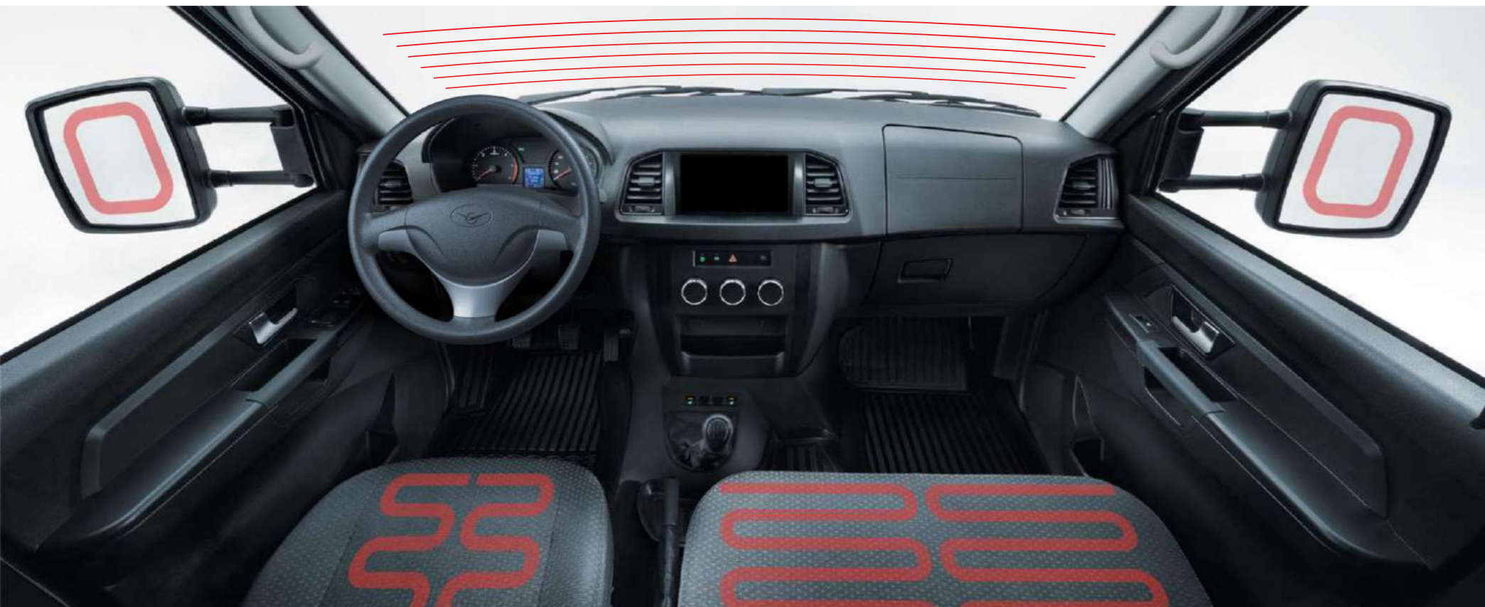
Подогрев зеркал заднего вида. Подогрев ветрового стекла, подогрев сидений (опционально, в зависимости от модификации).
